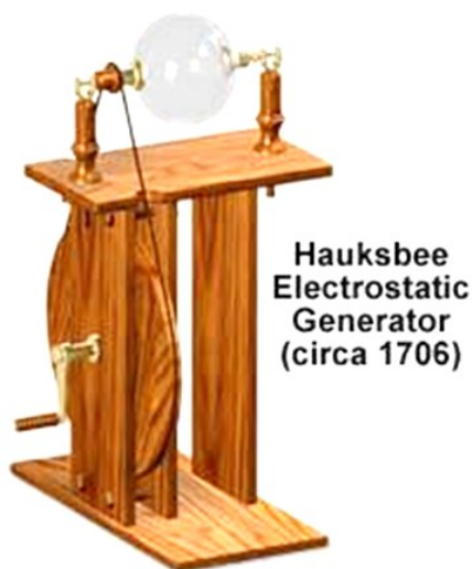
Рис. 1.5. Электростатический генератор Фрэнсиса Хоксби , 1706 г.
